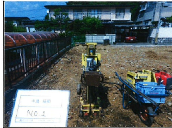
スウェーデン式サウンディング試験による地盤調査
